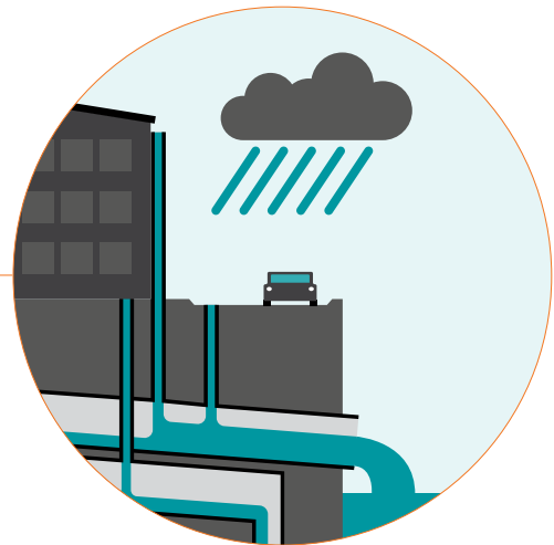
Separate Sewer Overflow (SSO)
